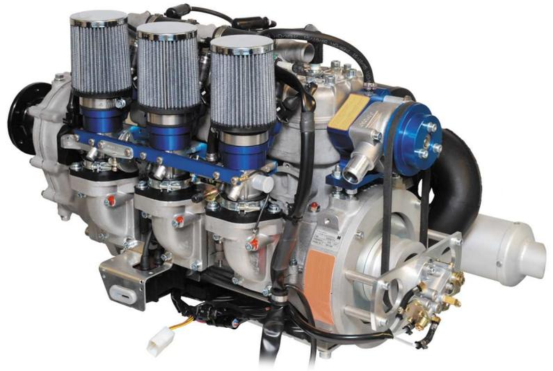
Der 3701 ES/VS ist ein flüssigkeitsgekühlter, membrange-steuerter 3-Zylinder-Reihen-2-Takt-Motor mit elektronischer Einspritzanlage oder Vergasern und Nikasilbeschichteten Zylindern.
